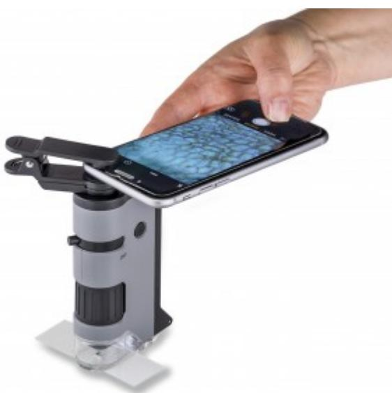
Microscope de poche extrêmement puissant avec fonction éclairage par LED.
