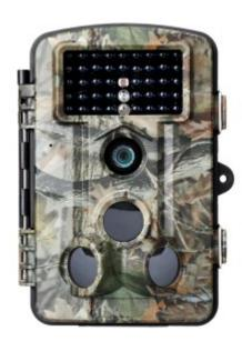
Piège photo 20Mp / Full HD / étanche IP56 / LED infrarouge / vision nocturne jusqu'à 20 m / grand angle / détection à 120 degrés. Led 940 nm complétement invisible
